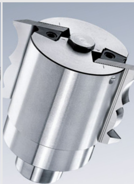
Moderna PowerLock glava za blanjanje, opremljena profilirnim noževima.
